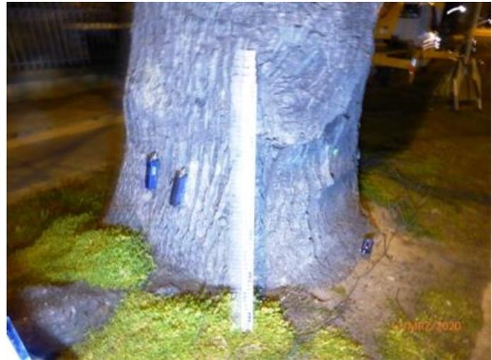
Abb. 18 Anordnung Messgeräte Zugversuch 1 und 2
