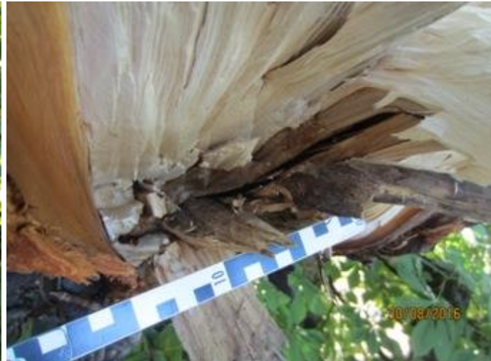
Abb. 22 Holzverfärbung an der Abbruchstelle
