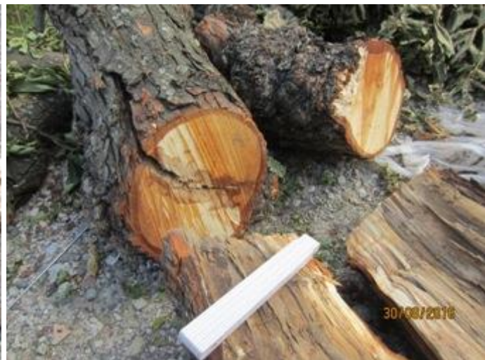
Abb. 27 Schubriss in der Ansicht
