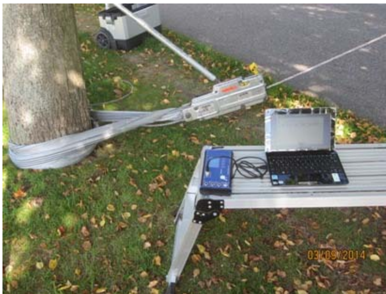
Abb. 2 Befestigung des Seiles am Widerlager, Seilzug, Empfangseinheit der Sensoren und Computer
