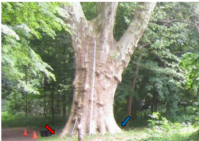
Abb. 3 Bereich der Krafteinleitung in die Krone aus den Lastrichtungen Westen (rot) und Norden (gelb)
