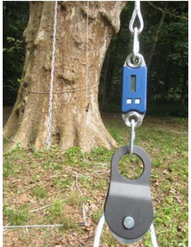
Abb. 4 Umlenkrolle und Kraftmessgerät
